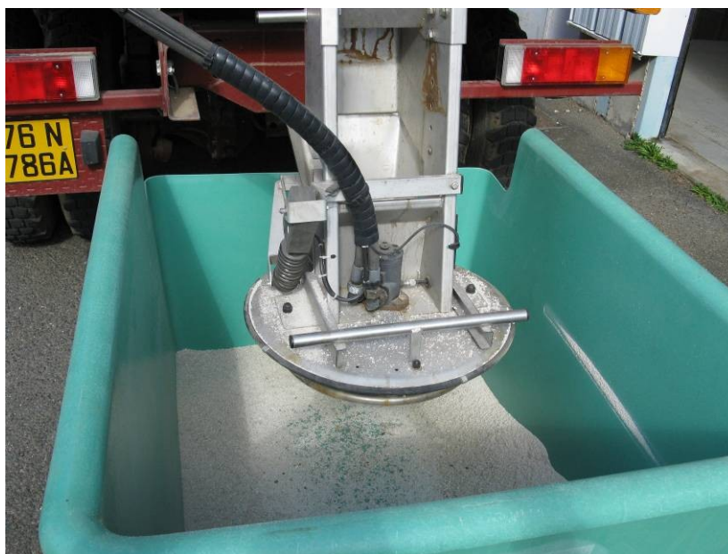
Photo 2 - épandage de sel dans la cuve de pesée
