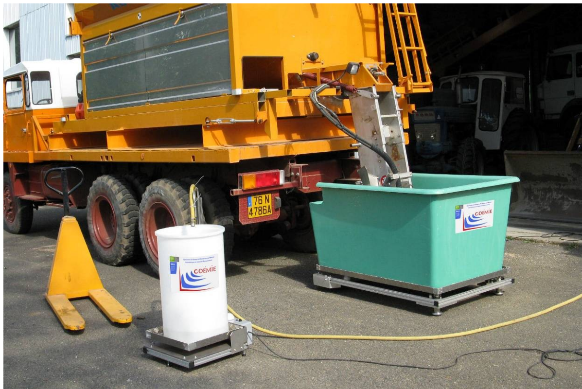
Photo 1 - Contrôle d'une épanduse avec le système
