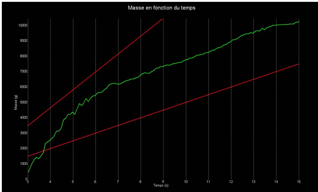
Figure 3 - Évolution de la masse de sel durant un essai
