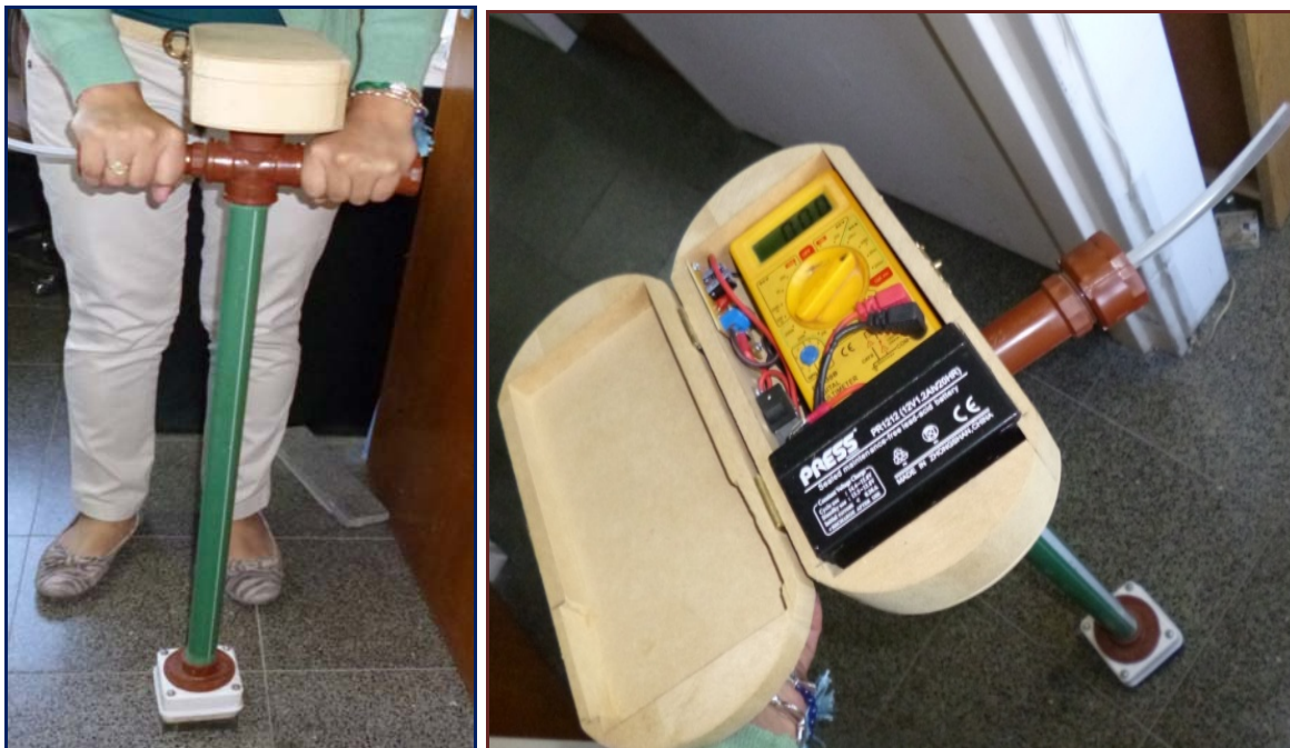
Figura 4 – Aparato desarrollado en la investigación en curso para medir residuo salino
