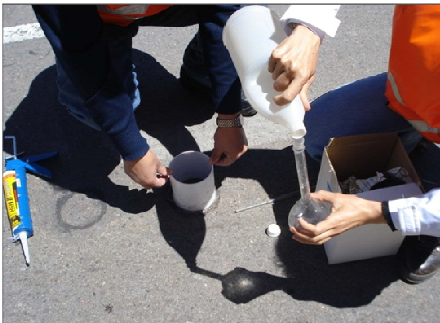
Figura 3 – Medición de residuo salino en estudios realizados por personal del 4º Distrito Mendoza de la DNV
