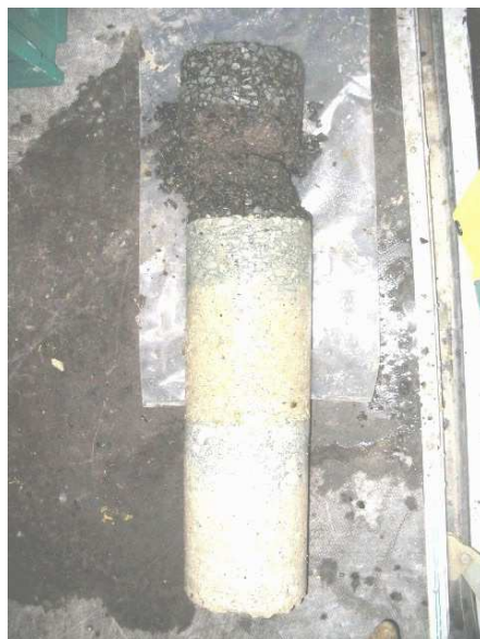
Figure 2 : Carotte prélevée au voisinage d'un nid de poule Désagrégation des anciennes couches de surface
