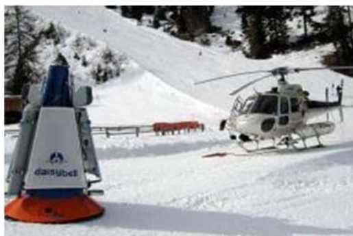
“Fotografía 2 - Explosor de gases tipo Daisybell”
