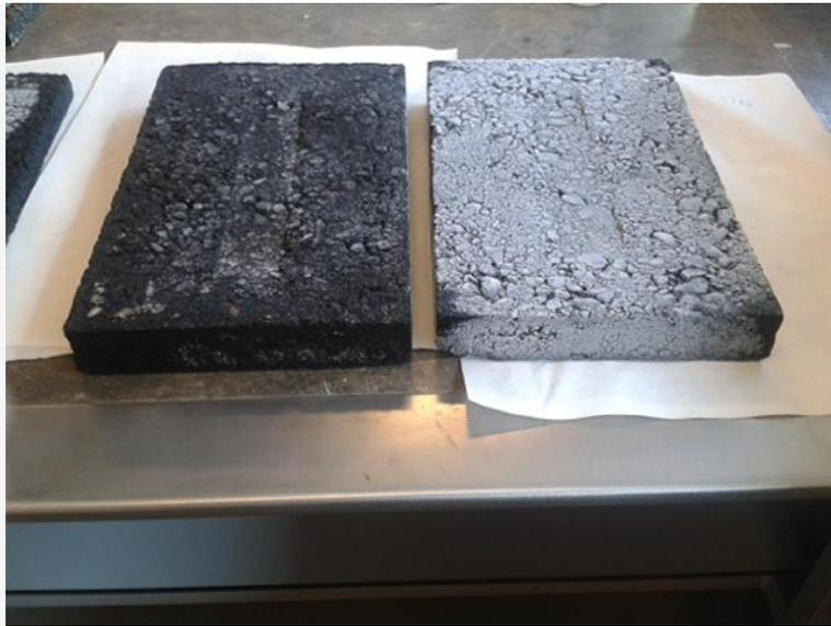
**Photo 1.- Les échantillons présentant le produit antigel (à gauche) et le mélange de référence (à droite)**
