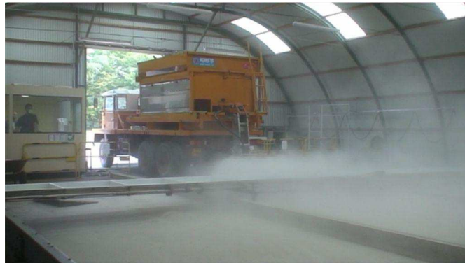
Figure 4. Vue d'ensemble du banc d'essais EPIR (cabine de commande, portique automoteur de récupération du sel, épandeuse testée)
