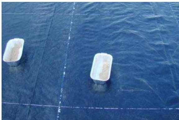
Figure 2. Récupération du fondant routier sur la piste d'essai
