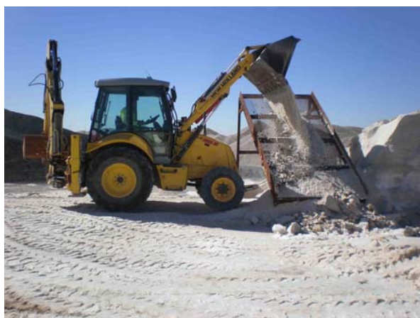
Fotografía nº 6 - Cribado de NaCl sobrante de una campaña de vialidad invernal
