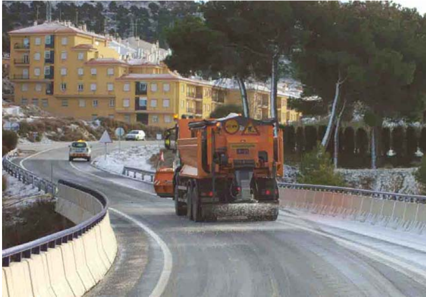
Fotografía nº 2 - Esparcidor de fundentes sólidos con sistema vía húmeda
