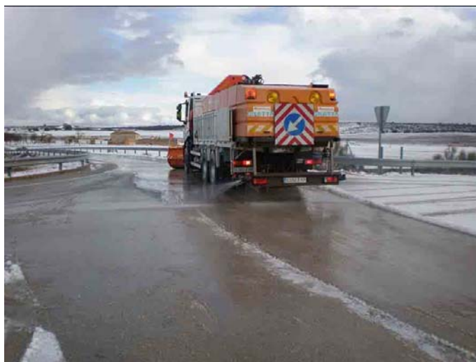
Fotografía nº 3 - Extendedor de fundentes en estado líquido
