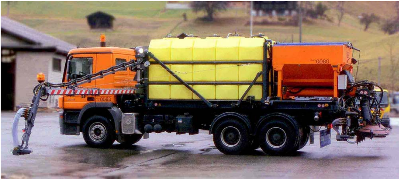
Fotografía nº 4 - Imagen de equipo extendedor de fundentes tipo "COMBI"
