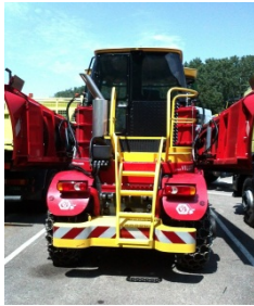
Fig. 11.1 - Accès par l'arrière de la cabine sécurisé par une plate-forme dans le gabarit du véhicule
