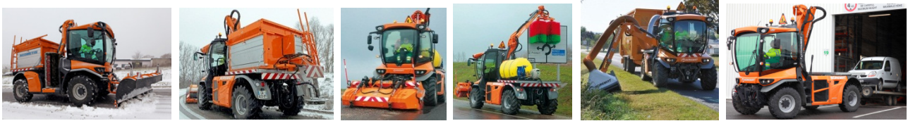
Fig. 12.3.b - Porte-outils dédié à l'exploitation des routes
