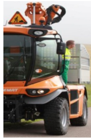
Fig. 11.1 - Accès par l'arrière de la cabine sécurisé par une plate-forme dans le gabarit du véhicule
