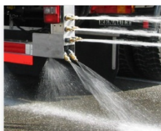
Fig. 3 - Epandage jusqu'à 5 voies par rampe et buses
