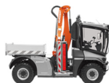
Fig. 12.3.a - Porte-outils avec bras de fauchage/débroussaillage intégré au porteur et pouvant accueillir jusqu'à trois outils en simultanément
