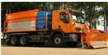
Fig. 1 - Cuve de saumure avant d'une machine mixte
