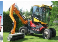
Fig. 12.2 - Porte-outils dédié pour fraise, étrave, lame, saleuse, broyeur de branches, faucheuse
