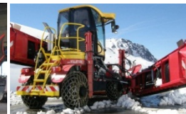
Fig. 12.2 - Porte-outils dédié pour fraise, étrave, lame, saleuse, broyeur de branches, faucheuse
