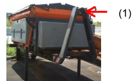
Fig. 6.2 - Saleuse sur berce après dépose
