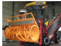
Fig. 12.2 - Porte-outils dédié pour fraise, étrave, lame, saleuse, broyeur de branches, faucheuse
