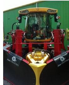
Fig. 11.2 - Cabine redessinée pour accroître la visibilité et l'ergonomie en cabine
