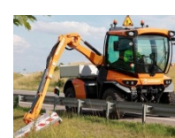
Fig. 12.3.a - Porte-outils avec bras de fauchage/débroussaillage intégré au porteur et pouvant accueillir jusqu'à trois outils en simultanément
