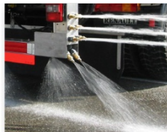
Fig. 3 - Esparcido hasta 5 carriles por rampa y toberas
