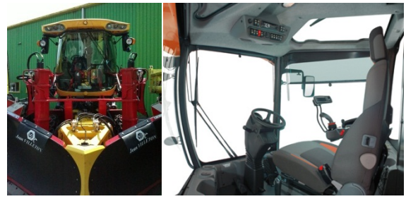
Fig. 11.2 - Cabina rediseñada para aumentar la visibilidad y la ergonomía del puesto de conducción
