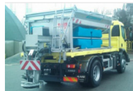
Fig. 2 - Depósito de salmuera laterales de una máquina mixta
