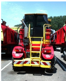
Fig. 11.1 - Medios de acceso que integran una plataforma en el gálibo del vehículo para un acceso protegido y por la parte trasera de la cabina
