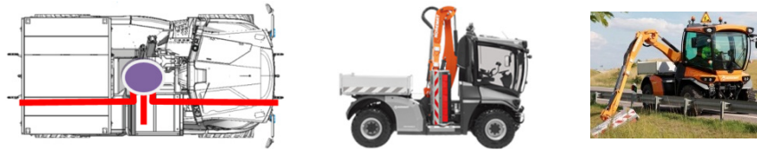
Fig. 12.3.a - Portaherramientas con brazo de siega/desbroce integrado en el portador y que puede recibir hasta tres herramientas simultáneamente
