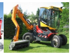
Fig. 12.2 - Portaherramientas específico para fresadora de nieve, cuña, hoja esparcidor de sal, triturador de ramas y brazo de siega
