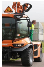
Fig. 11.1 - Medios de acceso que integran una plataforma en el gálibo del vehículo para un acceso protegido y por la parte trasera de la cabina
