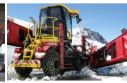
Fig. 12.2 - Portaherramientas específico para fresadora de nieve, cuña, hoja esparcidor de sal, triturador de ramas y brazo de siega
